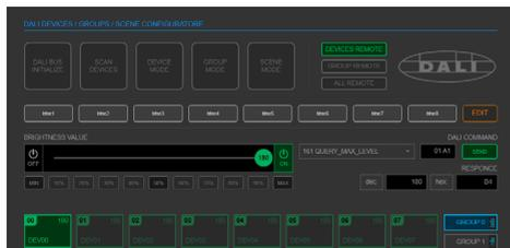
DEVICES REMOTE – режим управления отдельно выбранным прибором. Для начала работы выберите прибор, которым требуется управлять – подсветится более ярким цветом.
