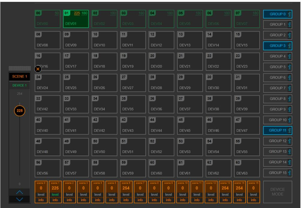
GRUPE MODE – следующий режим предназначен для быстрой группировки приборов.
