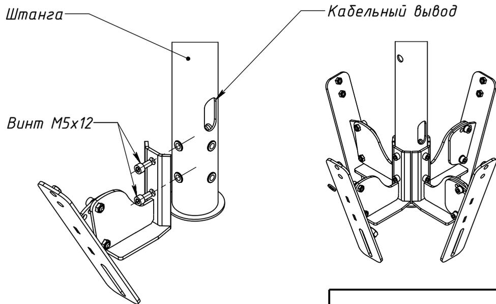
3. Закрепить монтажную пятку к перекрытию, соединить штангу с установленными поворотными площадками с монтажной пяткой. Между проушинами монтажной пятки и штангой установить проставки.
