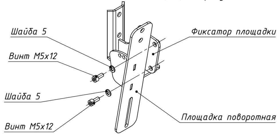
2. В зависимости от выбранной конфигурации, установить на перфорированную трубу 1-4 собранные Поворотные площадки с фиксаторами.
