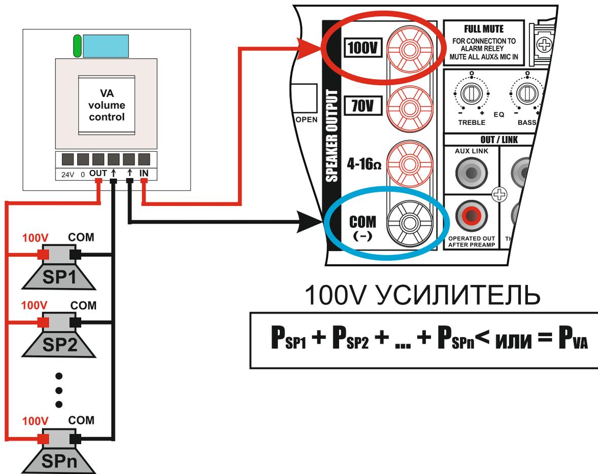
**ВАРИАНТ ПОДКЛЮЧЕНИЯ - НЕСКОЛЬКО ЗОНАЛЬНЫХ РЕГУЛЯТОРОВ**
