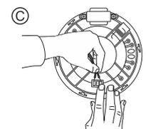
CPA6T имеют самозажимной клеммный терминал на три контакта. Для подключения на необходимую мощность нужно использовать контакт COM (-) и контакт соответствующий выбранной мощности (3W/100V или 6W/100V). Зачистите концы приходящего спикерного кабеля приблизительно на 4-5mm. Нажмите и удерживайте кнопку на клеммном терминале. Затем в открывшийся разъем поместите зачищенную часть кабеля и отпустите кнопку. Проверьте надежность фиксации кабеля.
