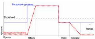
NOISE GATE предназначен для того, чтобы обрезать сигнал ниже указанного в настройках уровня. Таким образом можно настроить систему так, что полезный сигнал будет безприпятственно проходить через DSP процессор, а различный шум, например между треками приглушаться. Threshold - отвечает за значение порога срабатывания NOISE GATE, данная настройка определяет уровень сигнала ниже которого блок NOISE GATE продускать сигнала но билот. Он
