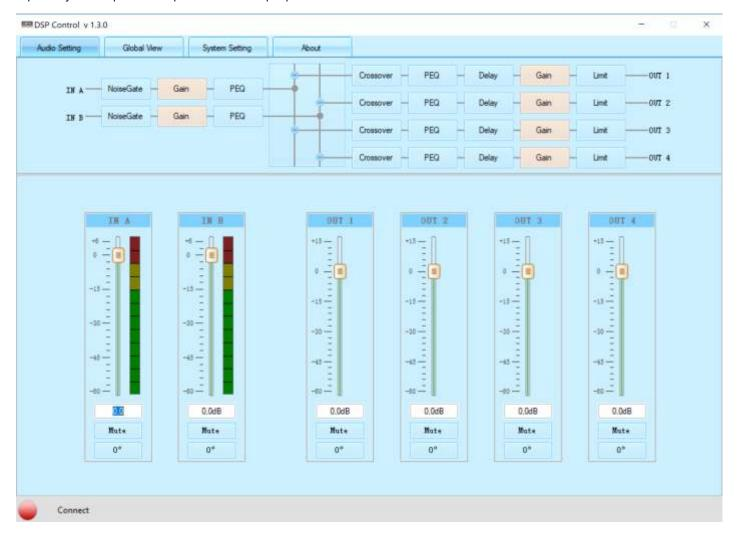
В левом нижнем углу показан находится индикатор подключения программного обеспечения к MDSP-42. Если он горит красным - соединение отсутствует, если зеленым - подключение есть. Физически MDSP-42 должен быть подключен USB кабелем к Вашему компьютеру на котором запущена программа DSP Control. Более подробно процесс подключения описан в разделе УСТАНОВКА ПРОГРАММНОГО ОБЕСПЕЧЕНИЯ DSP CONTROL
