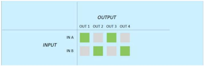
Зеленые квадраты обозначают на какой OUTPUT отправляется сигнал с любого из INPUT MDSP - 24. Например на картинке выше сделана следующая настройка - INPUT A подается на OUTPUT1 и OUTPUT3, а сигнал с INPUT В на выходы OUTPUT2 и OUTPUT4. То есть стерео вход раздается на два стере выхода. Фактически на INPUT А и INPUT В в том числе можно подать два разных моно сигнала и в этом случае система будет работать как аудио - матрица 2х4.
