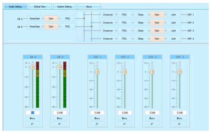
PEQ - входной параметрический эквалайзер на пять свободно управляемых частот. Используется для коррекции АЧХ входящего сигнала, а также для сглаживания негативного влияния на звук помещения, паразитных резонансов и так далее.
