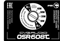
С обратной стороны корпуса под защитной крышкой располагается селектор для выбора режима работы и терминалы для подключения приходящего спикерного кабеля. Необходимо с помощью отвертки выбрать на селекторе низкоомный режим 8 омм или одну из четырех доступных в 100V режиме мощностей.
