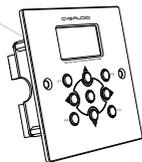
Два винта для фиксации контроллера CVGAUDIO ERC-1 в монтажной коробке
