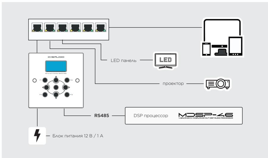
Вариант использования в качестве зональных контроллеров управления для многозональных аудио систем
