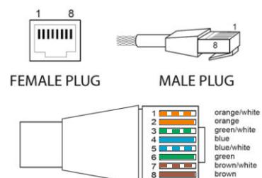
Микрофонная консоль CVGaudio MCP-8 подключается в матрице CVGaudioPM-380 с помощью кабеля CAT5E / CAT6 и может быть удалена на расстояние до 100м. Распиновка кабеля указана на рисунке выше.
